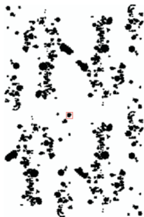
Рис. 3. Кластерное распределение стабилизирующей фазы 15%
