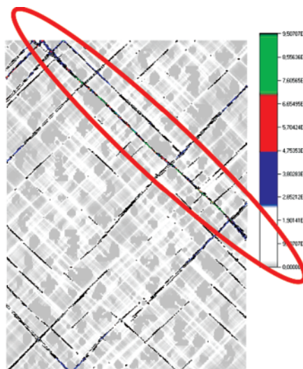
Рис. 4. Полосы локализованной неупругой деформации. Равномерное распредел. 15%
