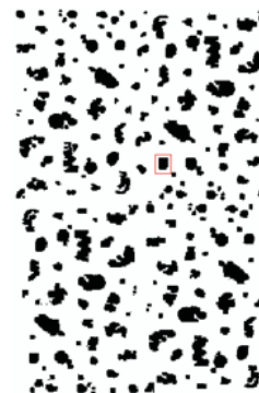
Рис. 2. Равномерное распределение стабилизирующей фазы 15%
