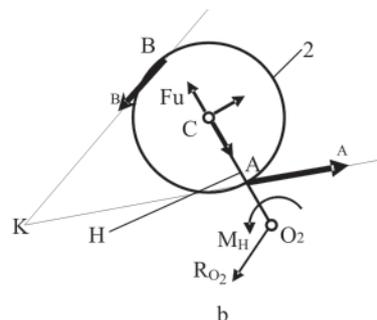
Прежде всего найдем тангенциальную составляющую  $R_{C1}^t$  в шарнире C из уравнения
