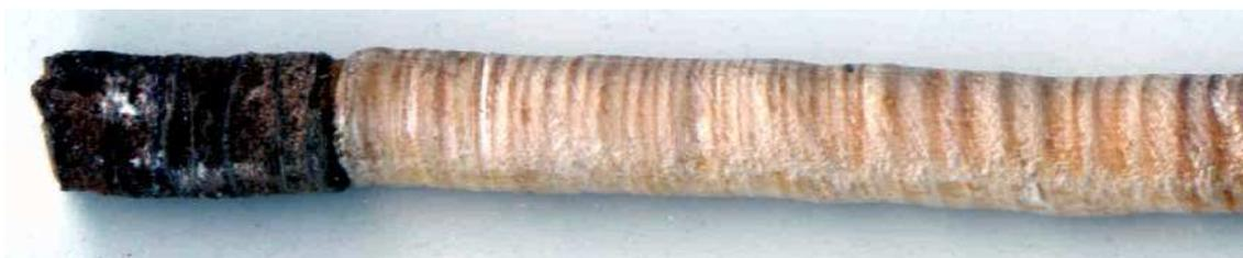
Рис. 2. Вид керна после сканирования
