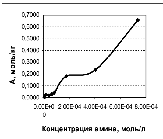
Рис. 3. Изотермы адсорбции додециламиния на кварце (А) и амфиболе (Б)
