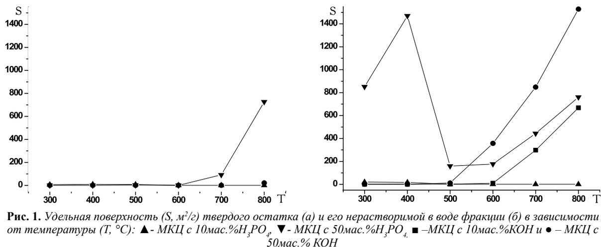
Рис. 1. Удельная поверхность ( $S$ ,  $m^2/g$ ) твердого остатка (а) и его нерастворимой в воде фракции (б) в зависимости от температуры ( $T$ ,  $^{\circ}C$ ):  $\blacktriangle$  - МКЦ с 10мас.% $H_3PO_4$ ,  $\blacktriangledown$  - МКЦ с 50мас.% $H_3PO_4$ ,  $\blacksquare$  - МКЦ с 10мас.% $KOH$  и  $\bullet$  - МКЦ с 50мас.%  $KOH$
