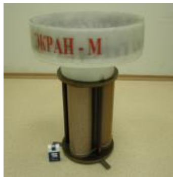
Рис. 1. Устройство для обработки посадочного материала «Экран-М»
