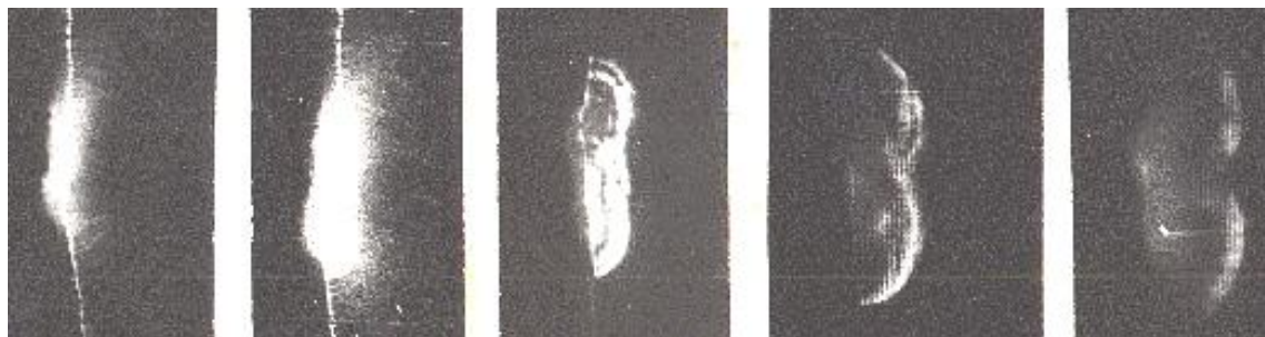
Рис. 4. Динамика расширения плазменного микрошнура. Излучающий разряд в воздухе, разрядный промежуток - 0,5 мм, аperiodический импульс тока с амплитудой 750 А имел длительность 400 нс. Экспозиция - 10 нс, интервал между кадрами - 100 нс.[12].
