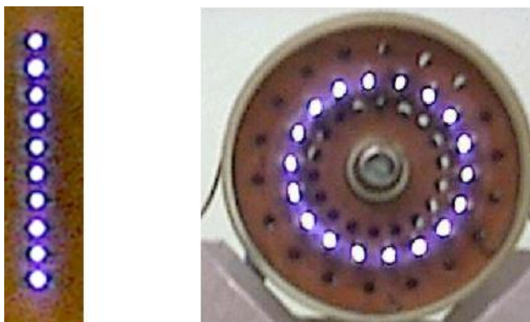
Рис. 3. Внешний вид моделей линейного и кольцевого источников УФ. Потребляемая мощность одной линейки или кольца до 100 Вт при напряжении до 3 кВ. Искровые промежутки организованы с зазором 0,2–0,3 мм и шагом 1 см. Импульсно-периодические разряды с частотой f = 1 кГц происходят между шайбами из Мо диаметром 3 мм. Искровые промежутки собраны с конденсаторами К15-5 (3,3 нФ, 3 кВ) по схеме Аркадьева-Маркса.
