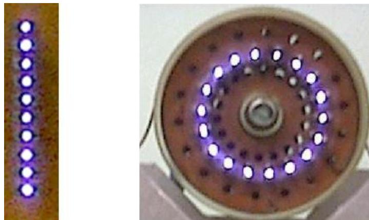
**Рис. 3.** Внешний вид моделей линейного и кольцевого источников УФ. Потребляемая мощность одной линейки или кольца до 100 Вт при напряжении до 3 кВ. Искровые промежутки организованы с зазором 0,2–0,3 мм и шагом 1 см. Импульсно-периодические разряды с частотой  $f = 1 \text{ кГц}$  происходят между шайбами из Мо диаметром 3 мм. Искровые промежутки собраны с конденсаторами К15-5 (3,3 нФ, 3 кВ) по схеме Аркадьева-Маркса.
