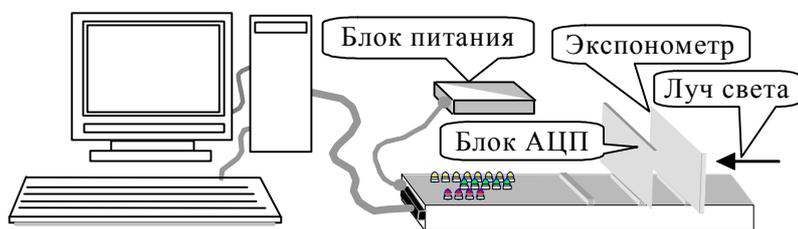
Рисунок 4. Условная схема установки цифровой экспонометр
