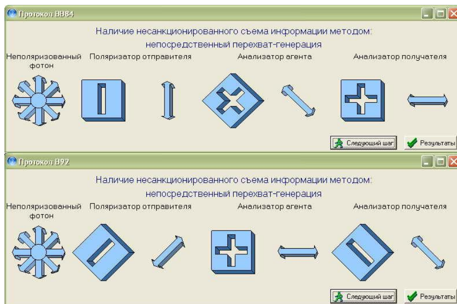
Рисунок 1. Пример работы протоколов BB84 и B92 при наличии НСД
